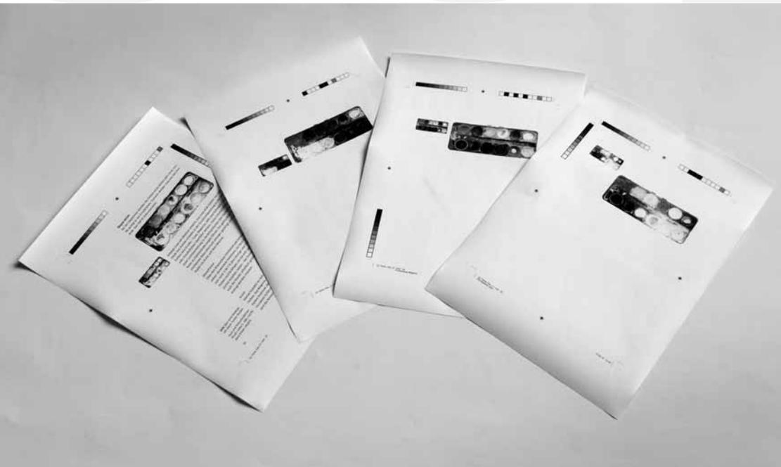
Werden farbige Bilder auf Digitaldruckern gedruckt, sieht man die einzelnen Farbauszüge nicht. Damit aber ein farbiges Bild entstehen kann, zerlegt auch der Druckertreiber eines billigen Tintenstrahldruckers das Bild zunächst in Ja/Nein-Informationen, also schwarz/weiße Farbauszüge. Erst im Zusammendruck entsteht dann das farbige Bild.
